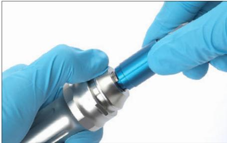
◀ Durch leichtes Drehen des Bohrkopfs Verkopplung sicherstellen.
